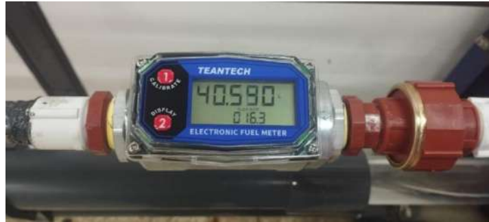
Ilustración 3-37. Caudal medido por el caudalímetro en el ensayo 1
