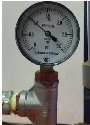
Ilustración 3-41. Presión del manómetro P3 con válvulas cerradas
