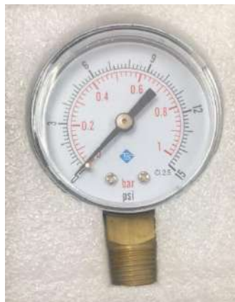
Ilustración 3-3. Manómetro 0 a 15 psi
