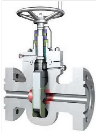
Ilustración 2-29. Válvula de compuerta
