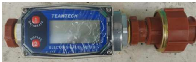
Ilustración 3-6. Caudalímetro para instalarse en la línea de tubería
