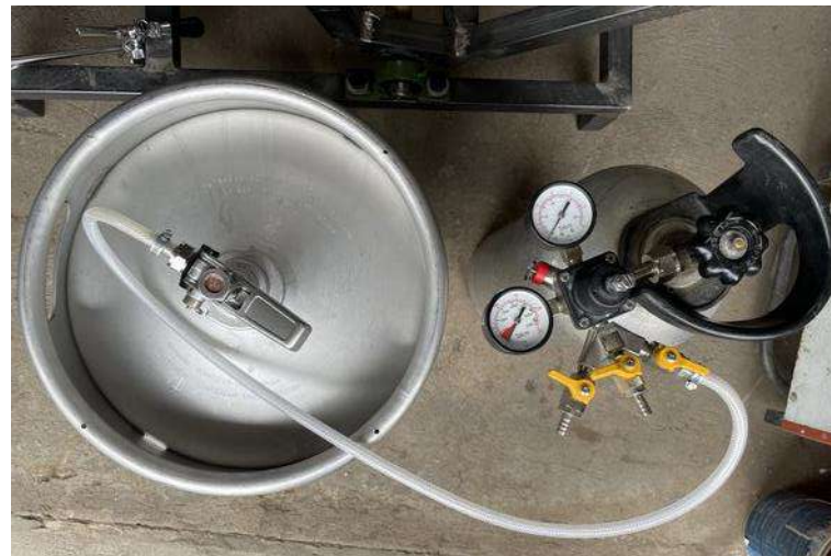
Ilustración 4-20: Inyección de CO 2
