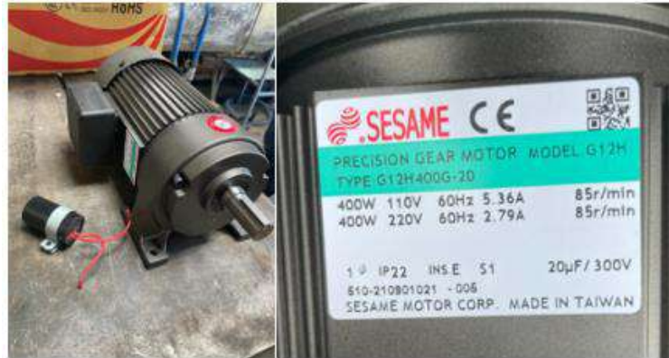
Ilustración 3-76: Motorreductor Sesame G12H 400G – 20.
