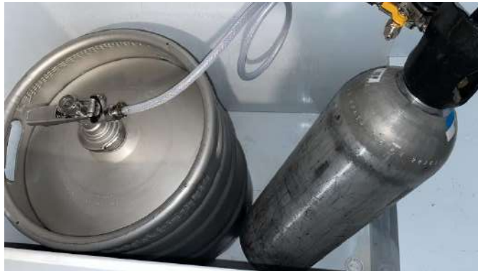
Ilustración 2-6: Inyección de dióxido de carbono
