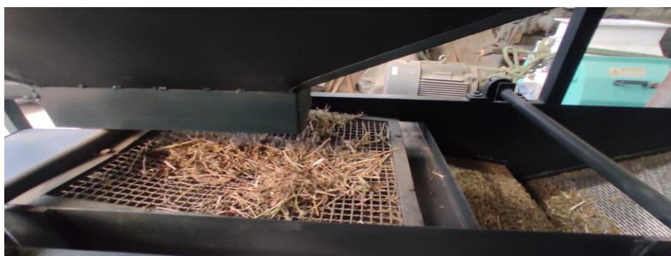
Ilustración 4-9: Primera malla de la maquina clasificadora Realizado por: Martínez B., 2023.
