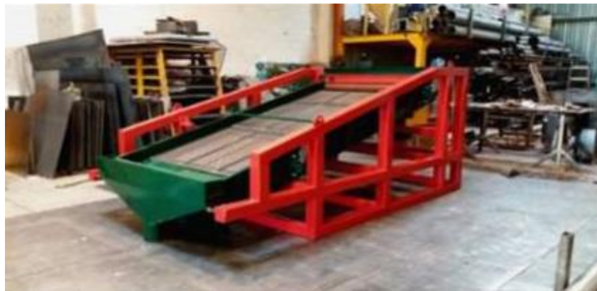
Ilustración 2-10: Máquina con zarandas vibratorias para la clasificación de granos. Fuente: (Paro, 2019)
