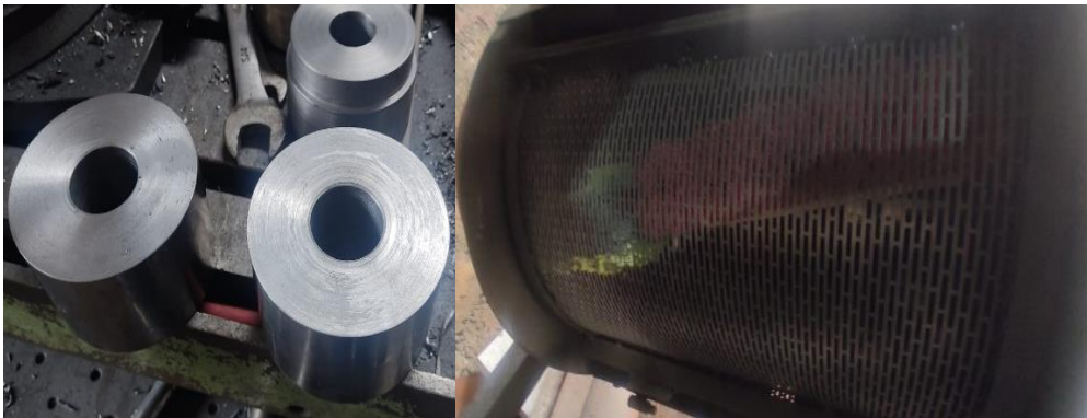
Ilustración 4-2: Mecnizado de volante de giro y malla para la limpiadora Realizado por: Martínez B., 2023.
