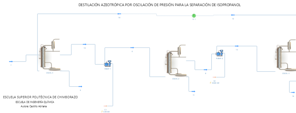
Ilustración 3-3: Esquema de la separación de isopropanol en DWSIM.
