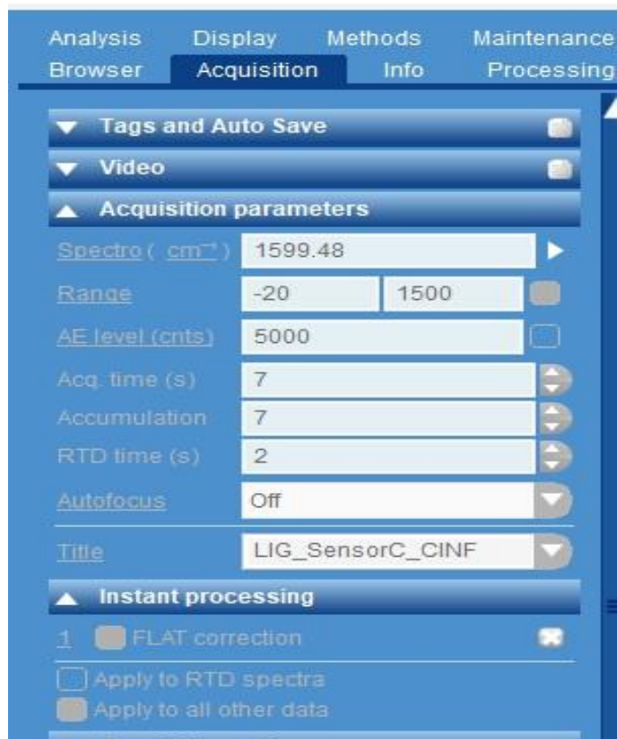
Ilustración 3-6: Configuración del equipo RAMAN para la obtención de datos
