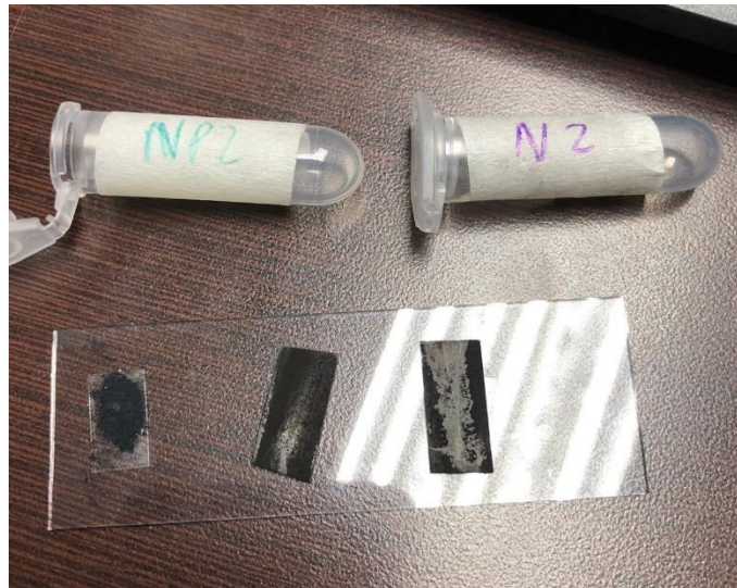
Ilustración 3-7: Muestras NP2 y N2 de NTC preparadas para caracterización RAMAN
