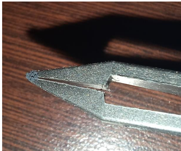
Ilustración 3-9: Porción extraída para caracterización RAMAN de la muestra Ni 2
