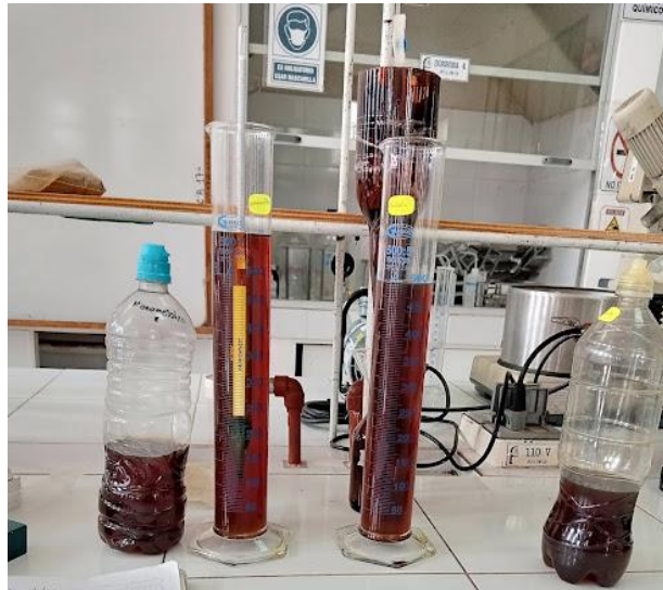
Ilustración 12-3: Determinación de la densidad API.
