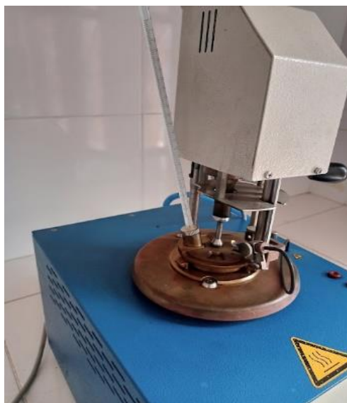
Ilustración 13-3: Determinación del punto de inflamación.
