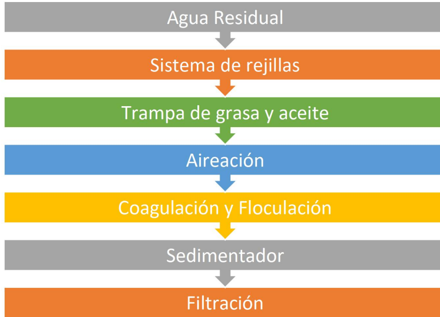
Ilustración 4-5: Diagrama del sistema de tratamiento de aguas residuales
