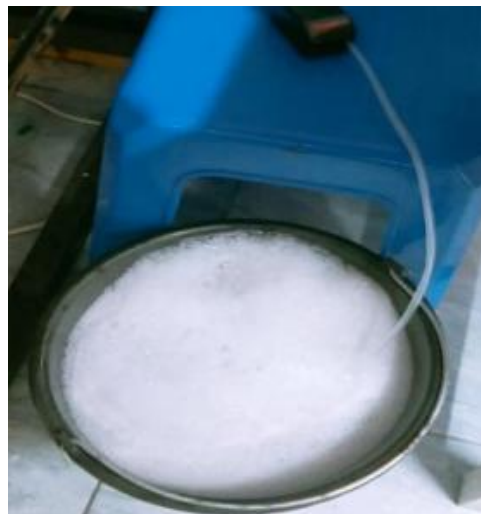
Ilustración 3-4: Proceso de aireación
