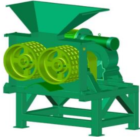
Ilustración 2-9: Briquetadora de rodillos
