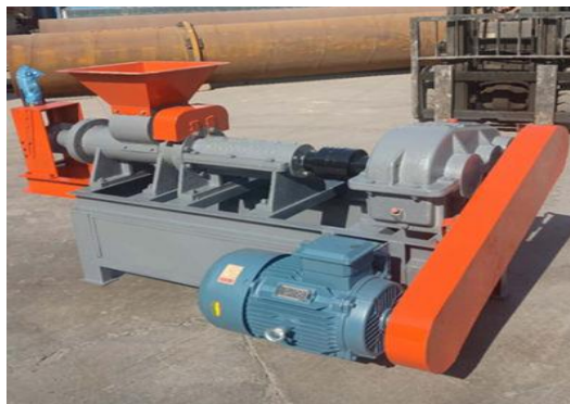
Ilustración 2-4: Briquetadora semi industrial
