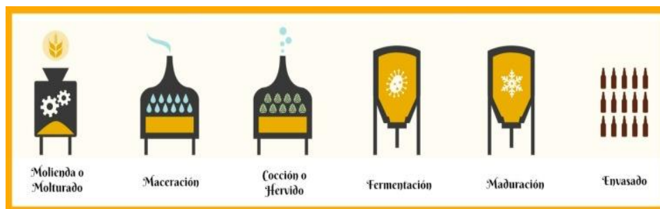
Ilustración 2-2: Proceso de elaboración de cerveza artesanal.
