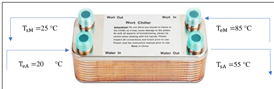
Ilustración 31-3: Enfriador de 20 placas
