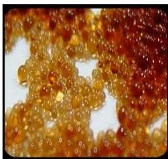
Compuesto químico poroso constituido por la mezcla de estireno y divinilbenceno (DVB) cargados porlarmente para que se produzca el intercambio iónico, dentro del ablandador se coloco un 80% de resina; 10% de grava y un 10% de arena su función será; en el momento de agitación en el proceso de ablandamiento desprender los carbonatos pregnados en la resina.
