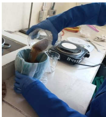
Ilustración 5-3: Filtración de BG
