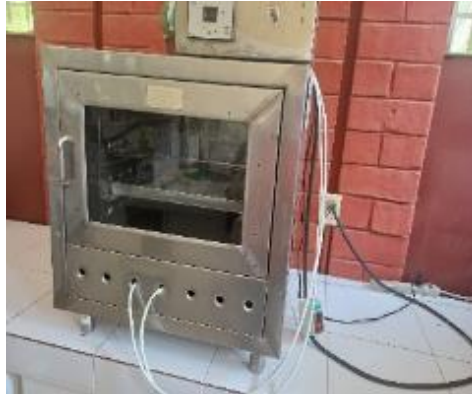
Ilustración 9-3: Secado de la materia prima
