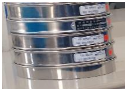
Ilustración 19-3: Torre de tamices
