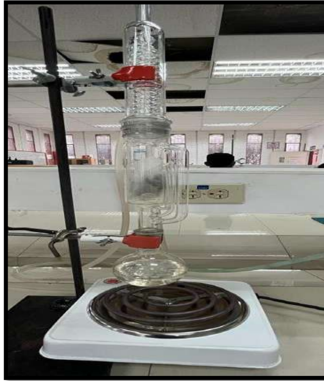
Ilustración 2-3: Equipo de extracción por el método de Soxhlet
