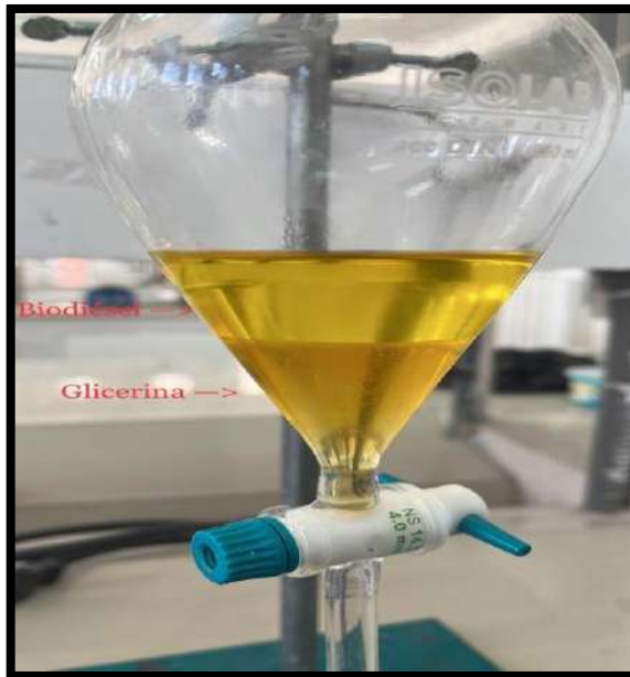
Ilustración 13-3: Mezcla después del proceso de transesterificación
