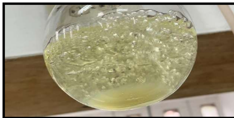
Ilustración 3-3: Presencia de grasa extraída por el método Soxhlet
