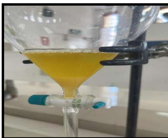
Ilustración 12-3: Mezcla después del proceso de transesterificación
