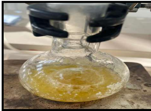
Ilustración 16-3: Mezcla durante el proceso de transesterificación
