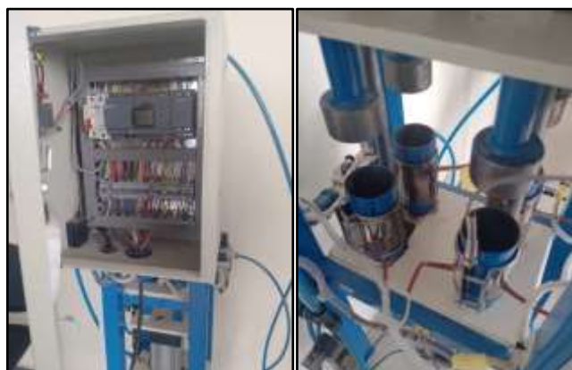
Ilustración 5-2: Briquetadora automatizada para producción semi-industrial
