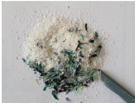
**Ilustración 10-4:** Muestra Pulverizada de la mezcla (PP, PS y catalizador)
