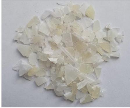
**Ilustración 8-4:** Muestra de recortes de poliestireno
