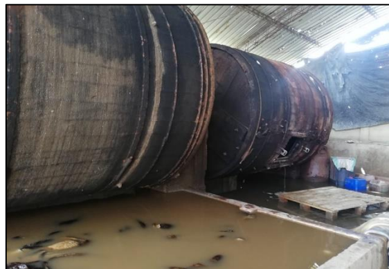
Figura 2-2: Bombos utilizados en etapa de ribera Realizado por: Telenchano René, 2021.
