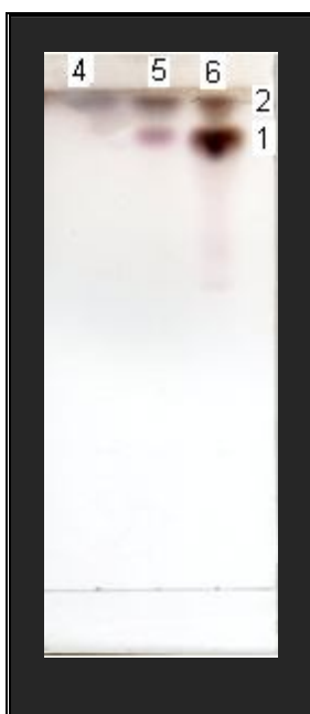
FOTOGRAFÍA No 5. CROMATOGRAFÍA EN CAPA FINA DE LAS FRACCIONES 4, 5 Y 6 DE LA EXTRACCIÓN EN COLUMNA FLASH DE SILICAGEL, SISTEMA DE SOLVENTES: CHCl 3 - CH 3 OH - H 2 O (60:40:4, V/V), REVELADOR VAINILLINA SULFÚRICA. FACULTAD DE CIENCIAS. ESPOCH. RIOBAMBA. DICIEMBRE DE 2011.
