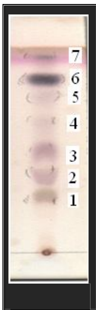
FOTOGRAFÍA No 2. CROMATOGRAFÍA DEL EXTRACTO METANÓLICO DE Genipa americana L., SISTEMA DE SOLVENTES: CHCl 3 - CH 3 OH- H 2 O (60:40:4, v/v), REVELADOR VAINILLINA SULFÚRICA. FACULTAD DE CIENCIAS. ESPOCH. RIOBAMBA. DICIEMBRE DE 2011
