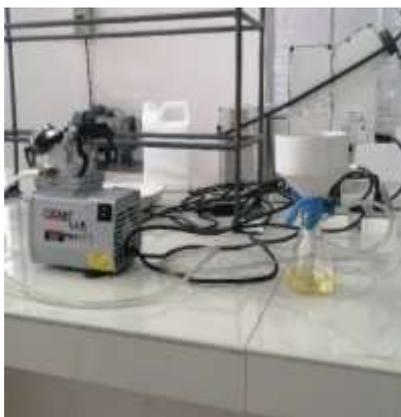
**Figura 8-3:** Filtración del extracto clorofórmico
