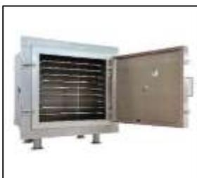
**Figura 6-2:** Secador de bandejas
