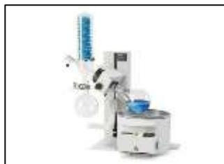
**Figura 3-2:** Equipo rotaevaporador
