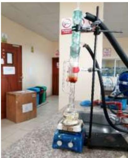
**Figura 9-3:** Extracción en Soxhlet
