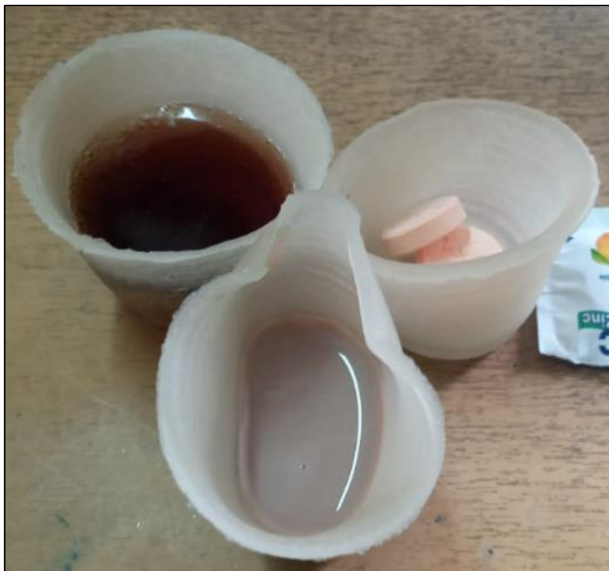
Figura 3-3. Prueba piloto del bioplástico de achira verde ( Canna edulis ).
