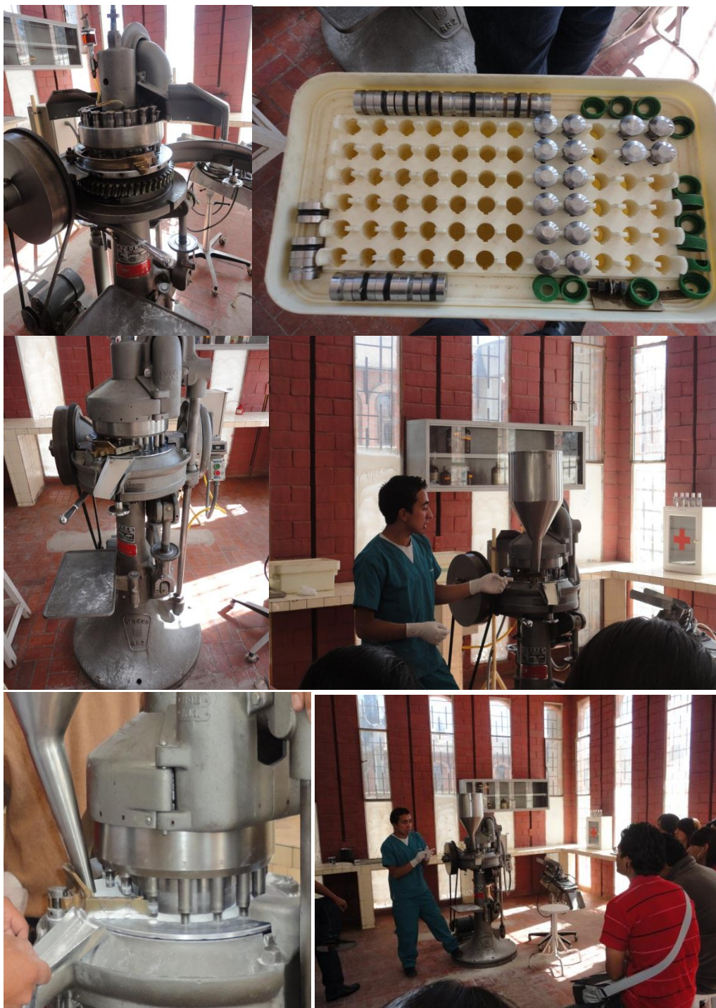
FOTOGRAFÍA No 2 COMPRESIÓN DEL PLACEBO EN TABLETEADORA STOKES
