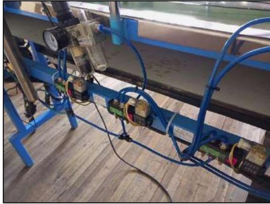
**Ilustración 3-11:** Electroválvulas del sistema neumático
