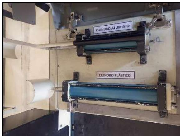
**Ilustración 3-7:** Sistema neumático, cilindros de doble efecto
