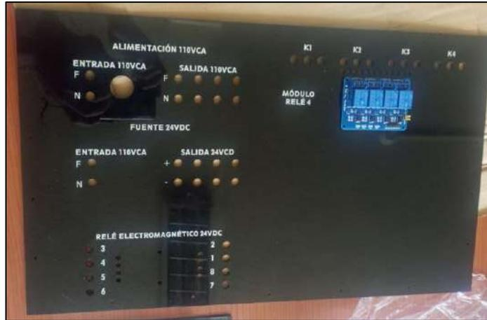
**Ilustración 3-30:** Placa PMMA
