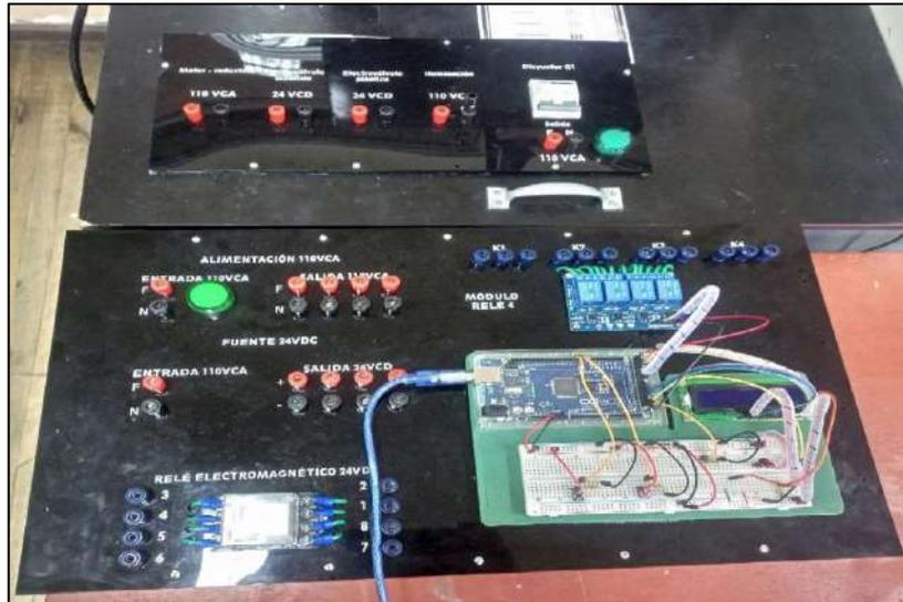
**Ilustración 3-33 (A):** Módulos del proceso de selección y clasificación de botellas
