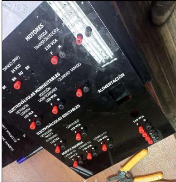
**Ilustración 3-31:** Placa PMMA con borneras Jack tipo banana
