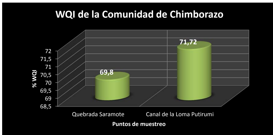
GRÁFICO N° 8 Resultados del índice de calidad de agua (ICA o WQI) en los puntos de monitoreo de la Comunidad Chimborazo.
