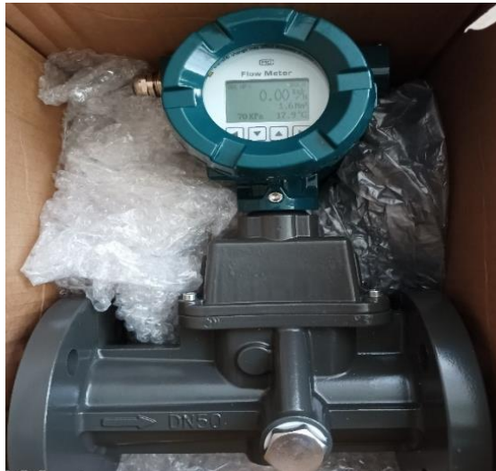
Ilustración 3-12: Medidor de flujo de gas pobre.
