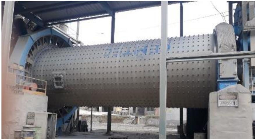
**Figura 18-3:** Molino de Cemento CM4
