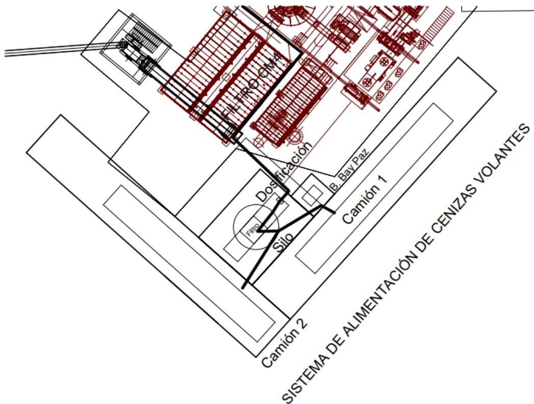
**Figura 14-5:** Layout del sistema de adición de cenizas volantes en molino CM4
