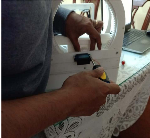
Figura 62-5. Montaje de motores
