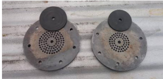
Figura 5-4: Válvula de descarga. Realizado por: (Flores, Jorge 2023).
