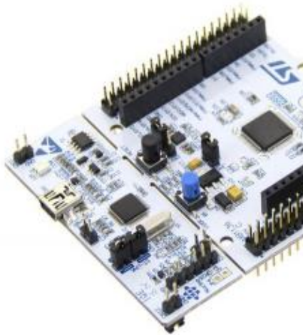
Figura 15-4: STM32 Núcleo F030R8 Fuente: (Perles, 2019).
