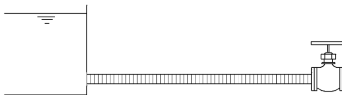
Figura 10-2: Depresión en toda la tubería de alimentación Fuente: (Mataix, 1997).
