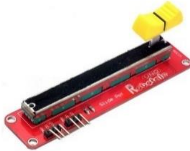
Figura 9-4: Potenciómetro Lineal. Fuente: (Peña, 2020).
