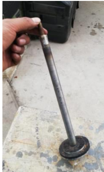
Figura 4-4: Asiento y vástago de válvula.
