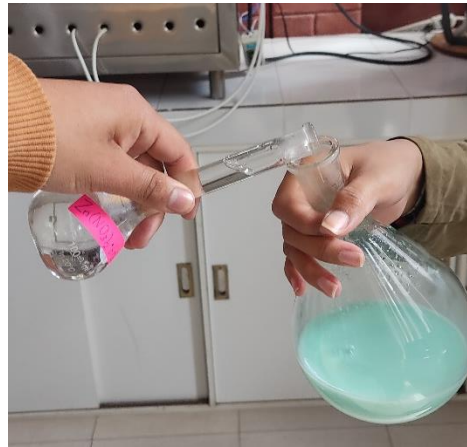
E2. Incorporación de la zeolita ZSM-5 con Nitrato de Níquel hexahidratado y Nitrato de Zinc hexahidratado.
