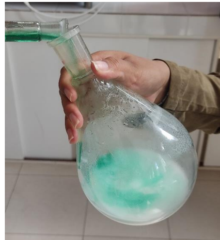
D2. Incorporación de la zeolita ZSM-5 con Nitrato de Níquel hexahidratado.
