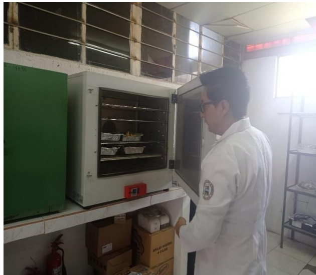
Ilustración 4-2: Deshidratación de las muestras
