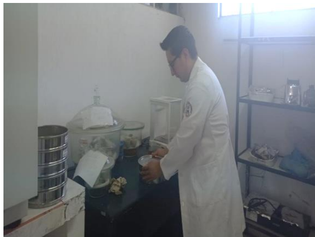
Ilustración 6-2: Tamizaje granulometría de 500 micrones
