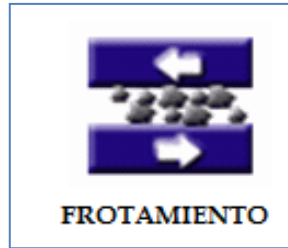
Fig. 1.2-4 Reducción de Tamaño por Frotamiento
