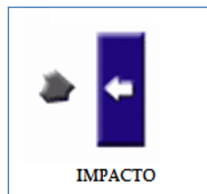
Fig. 1.2-3 Reducción de Tamaño por Impacto
