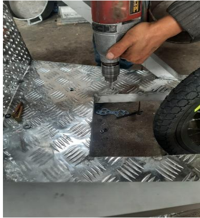
Figura 3-3: Perforación del chasis
