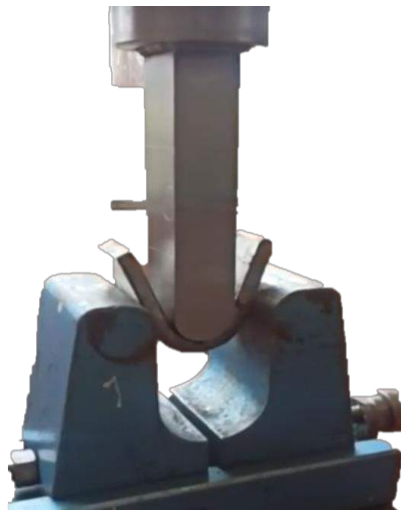
Ilustración 10-4: Proceso de doblado de cara en la junta soldada
