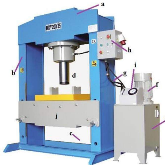
Ilustración 4-2: Partes básicas de una prensa hidráulica
