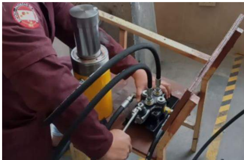
Ilustración 1-4: Prueba de estanqueidad en el cilindro hidráulico
