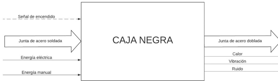
Ilustración 2-3: Caja negra del sistema accionador de la prensa
