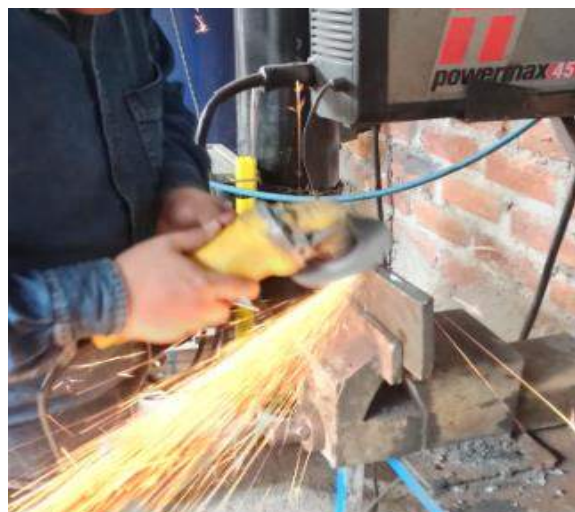
Ilustración 3-4: Creación de bisel en placas base
