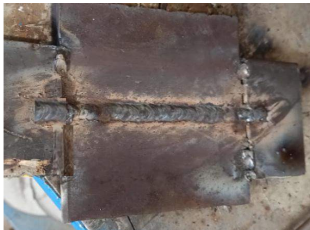
Ilustración 5-4: Placa completamente soldada
