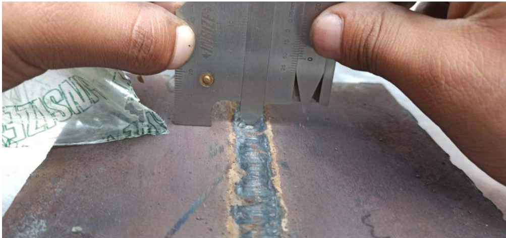
Ilustración 6-4: Medición de la altura del refuerzo de cara
