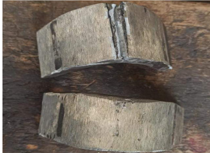
Ilustración 11-4: Inspección visual de la probeta doblada
