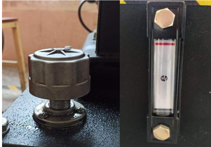
Ilustración 27-3: Instalación del filtro de aceite y medidor de nivel en el depósito
