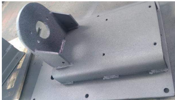
Ilustración 15-3: Fondeada y pintada de la base para bomba y motor
