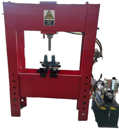
Ilustración 29-3: Sistema hidráulico implementado en la prensa
