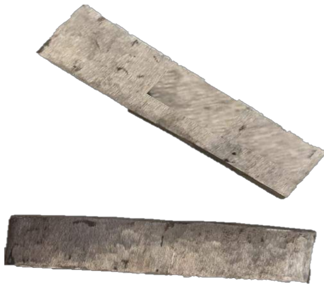
Ilustración 9-4: Preparación de las probetas para doblado
