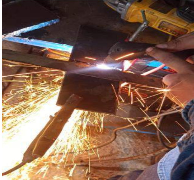
Ilustración 2-4: Corte mediante plasma de las placas
