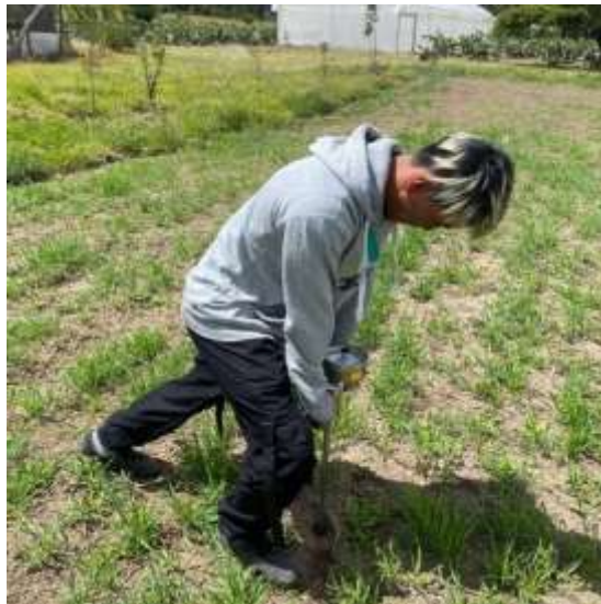
Ilustración 3-5: Toma de datos de compactación.
