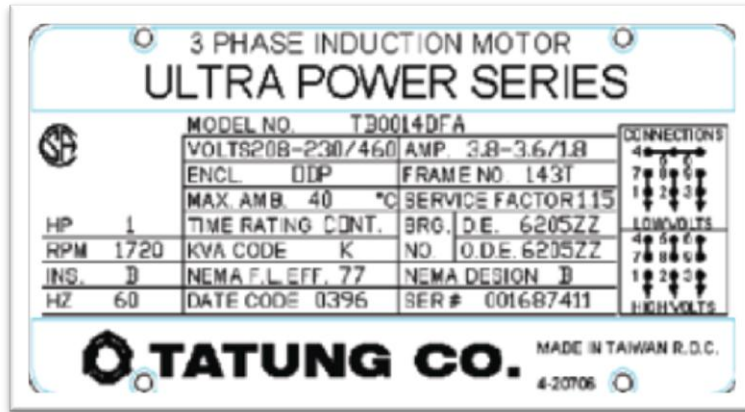
Figura II. 17 Datos de placa de motores eléctricos.
