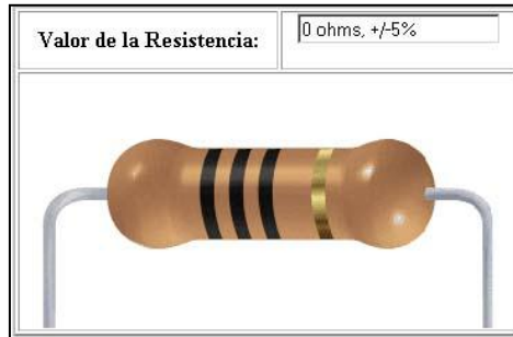
Figura IV. 45 Apariencia física de una resistencia eléctrica con sus valores en ohmios y tolerancia.
