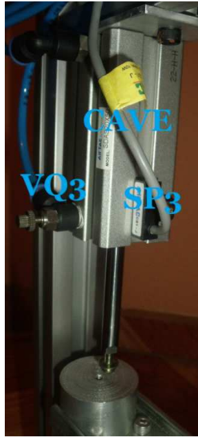
Fig. IV.9 Montaje del cilindro de avellanado CAVE.
