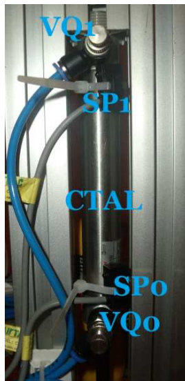
Fig. IV.7 Montaje del cilindro del taladro CTAL.
