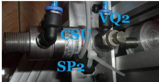
Fig. IV.8 Montaje del cilindro de sujeción CSUJ.
