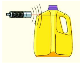
Fig. II.8 Detección de nivel a través de barrera.
