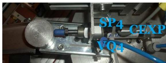
Fig. IV.10 Montaje del cilindro de expulsión CEXP.
