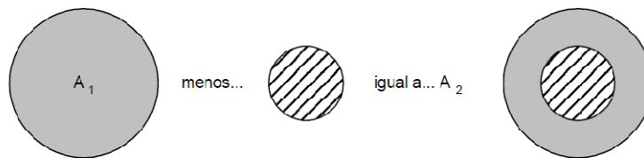
Fig. II.22. Diferencia entre las secciones efectivas de un cilindro.
