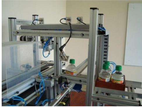
**Figura III.44:** Módulo de Paletizado
