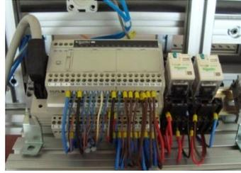
**Figura III.41:** Cableado entre el módulo de envasado y el PLC
