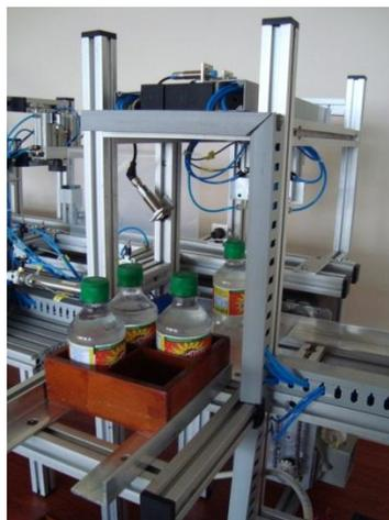
**Figura III.46:** Módulo de paletizado. Vista frontal
