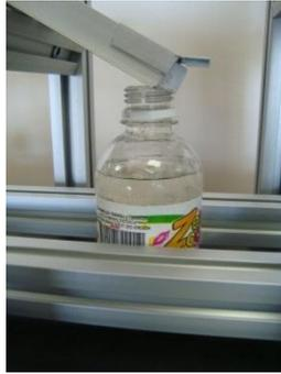
**Figura IV.22:** Recogimiento de la tapa por parte de la botella
