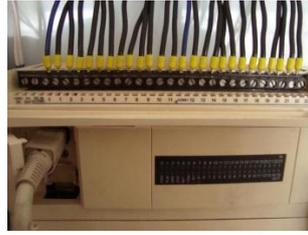
**Figura III.23:** Conexión de las entradas del PLC
