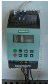
**Figura III.20:** Montaje del variador de frecuencia
