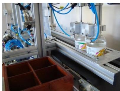
**Figura IV.30:** Cilindro C1P baja y ajusta las botellas con C3P
