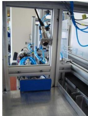
**Figura III.48:** Sensor óptico 4 y cilindro C2P de empuje del pallette.
