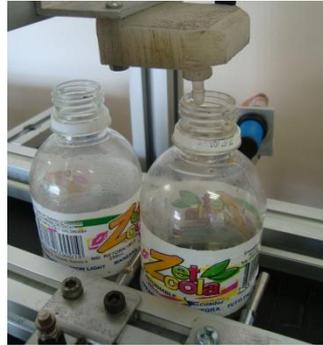
**Figura IV.20:** Botellas retenida por el cilindro A (C1)
