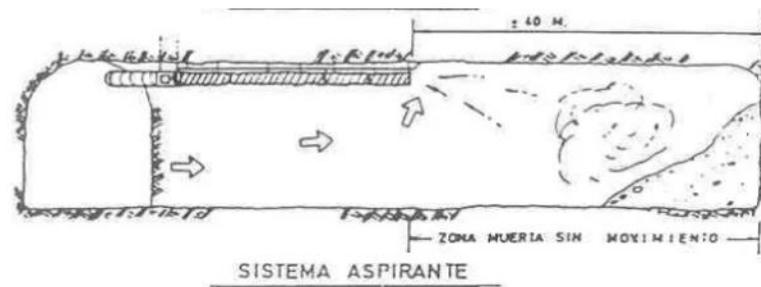
**Ilustración 2-1:** Sistema de ventilación aspirante
