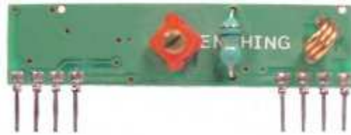
Fig. III.15.- Módulo de recepción inalámbrica RWS-434.
