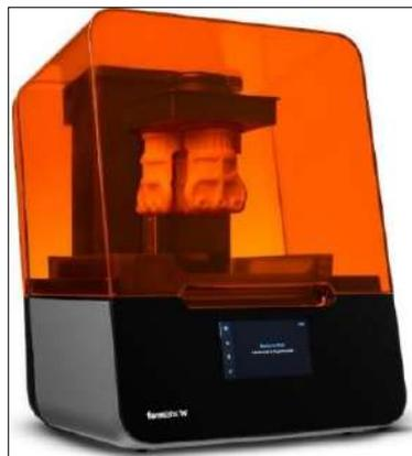
**Ilustración 25-2:** Impresora 3D DLP o resina
