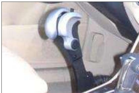
**Ilustración 10-2:** Leva vertical de acelerador y freno
