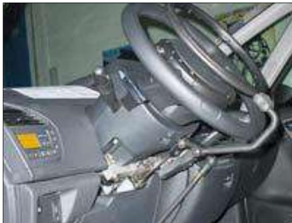
**Ilustración 8-2:** Acelerador mecánico de aro con freno a la mano
