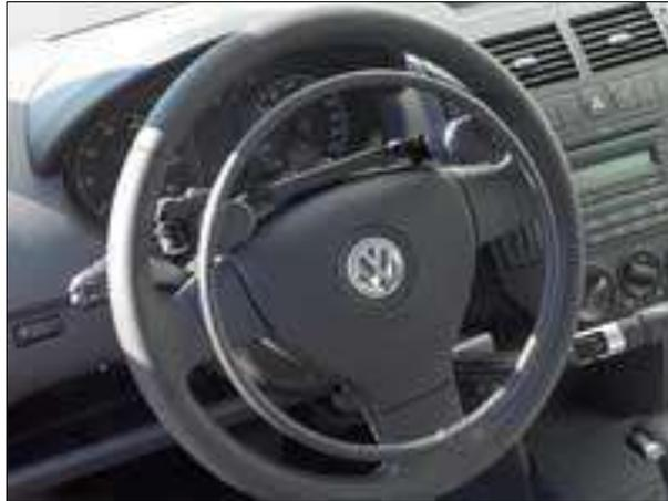
**Ilustración 7-2:** Acelerador electrónico de aro
