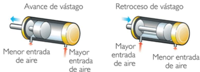
Fig. N° 3.15 Funcionamiento de un cilindro neumático de doble efecto
