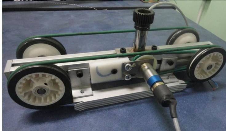
Fig. N° 4.12 Motor acoplado a la banda transportadora
