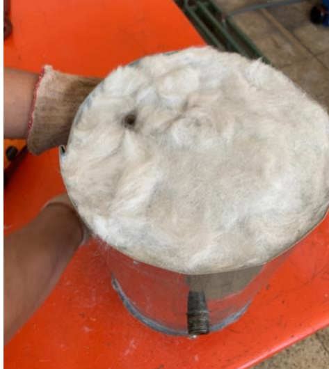
Ilustración 9-4: Implementación de nueva lana de vidrio en la cámara de expansión
