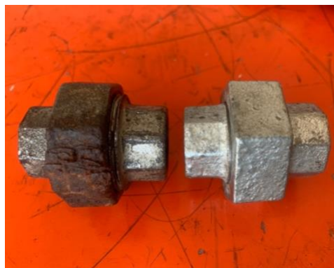
Ilustración 10-4: Unión universal antigua y unión universal nueva de la tubería del calorímetro
