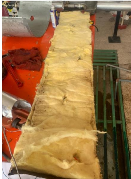
Ilustración 8-4: Extracción de la lana de vidrio de la cámara de expansión
