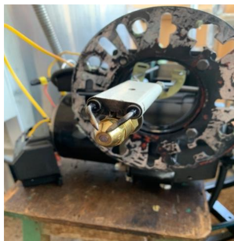
Ilustración 5-4: Boquilla antigua de 0,5 gph a 80° en el quemador.
