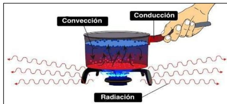
**Ilustración 1-2:** Transferencia de Calor
