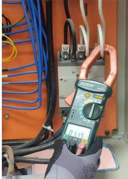
4. Procedemos a la conexión del equipo en el panel de control del transformador.
