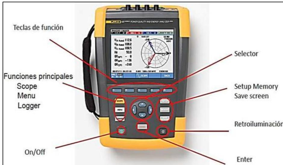
**Figura 16-2:** Información de las partes del equipo analizador de energía
