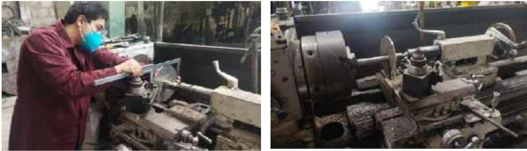
**Ilustración 32-4:** Proceso de torneado en el mecanizado de la turbina
