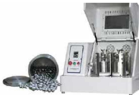
**Ilustración 5-2:** Molino pulverizador de bolas
