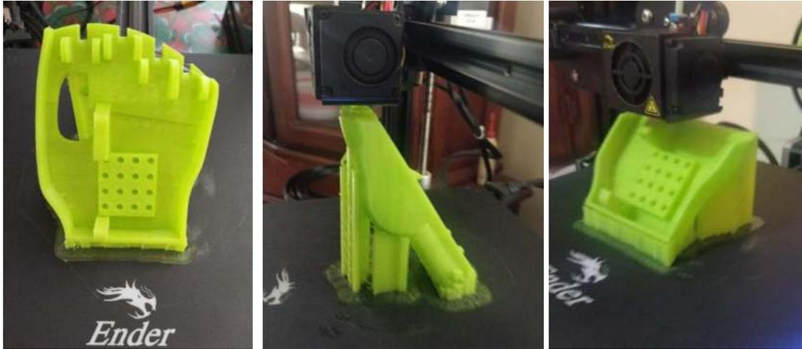
**Ilustración 40-3:** Impresión 3D del primer modelo
