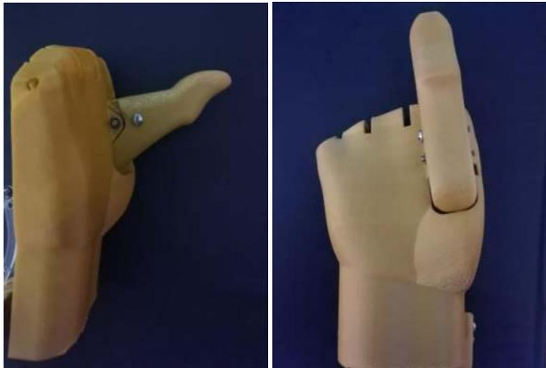
**Ilustración 47-3:** Impresión palma del prototipo dos
