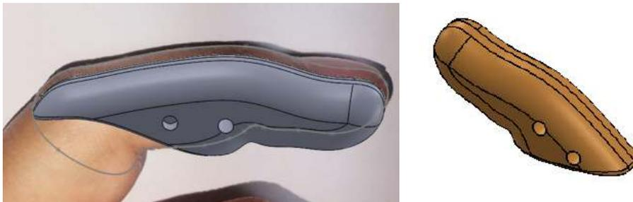
**Ilustración 13-2:** Diseño y dimensionamiento del dedo meñique
