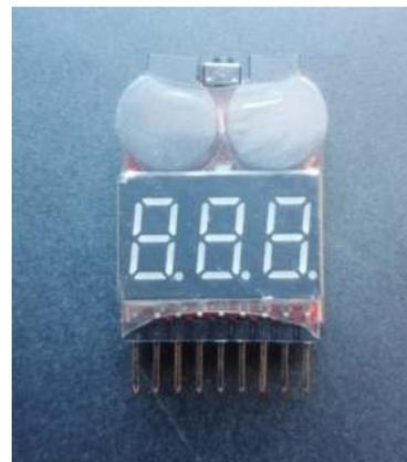
**B.** Probador de voltaje de batería de Litio
