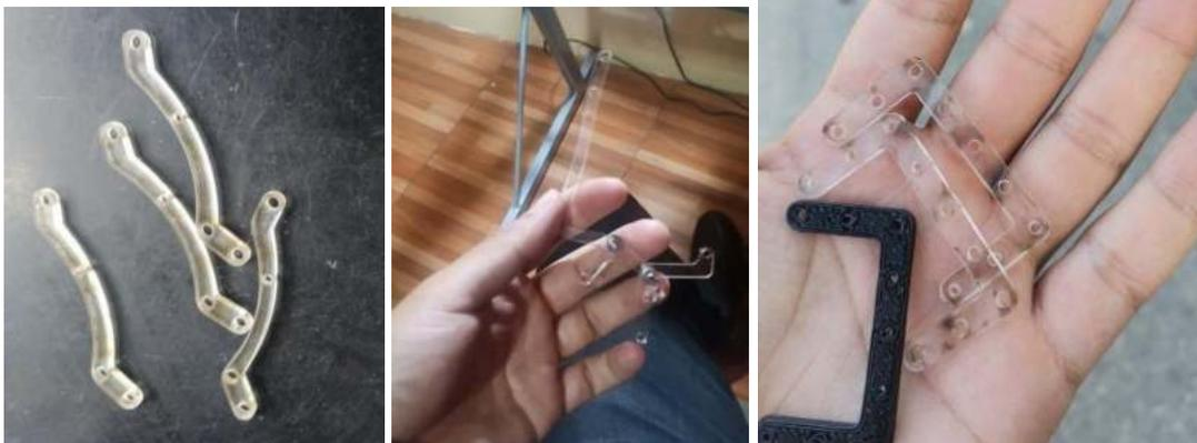
**Ilustración 43-5:** Eslabones cortados en láser para la prótesis de mano
