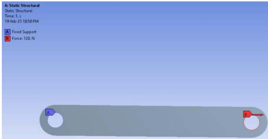
**Ilustración 33-4:** Eslabón recto del mecanismo
