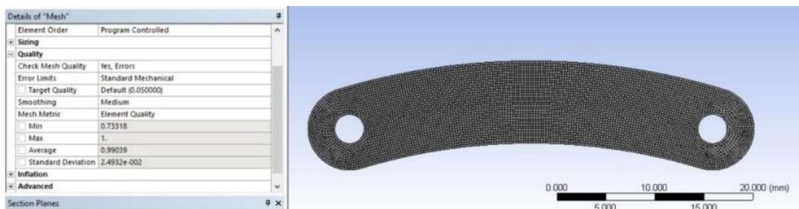
**Ilustración 35-3:** Calidad de la malla implementando método de elemento finito
