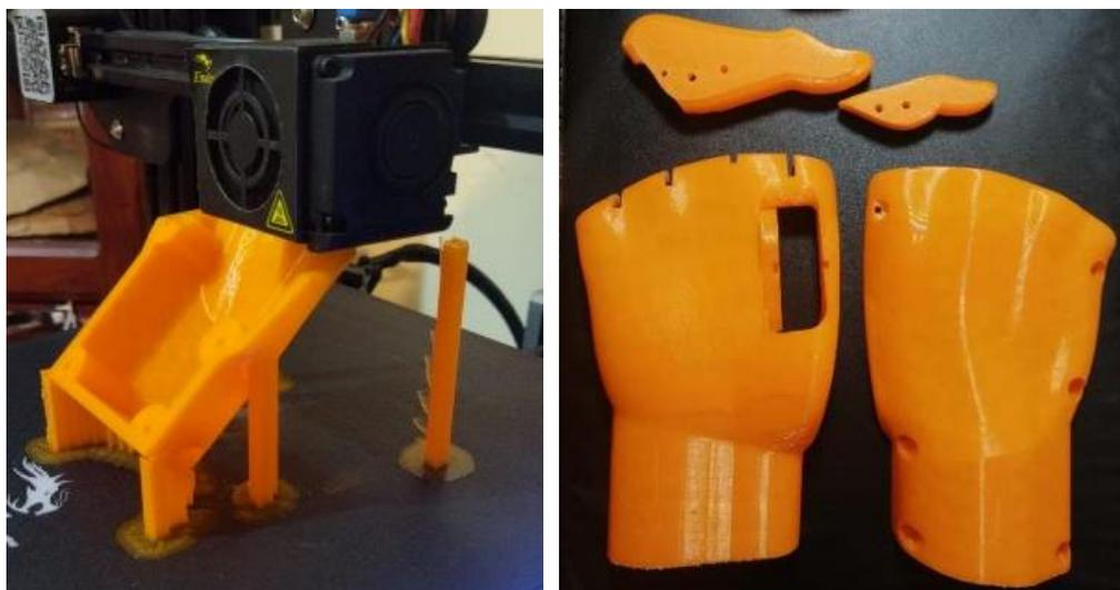
**Ilustración 45-3:** Impresión 3D prototipo uno prótesis de mano
