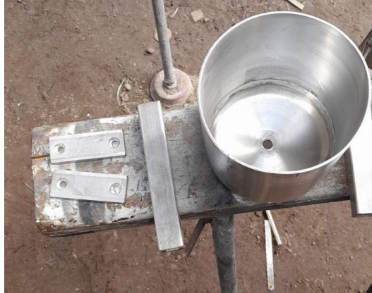
Ilustración 49-3: Mezclador de acero inoxidable
