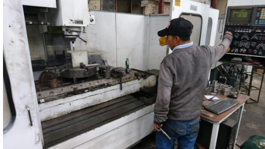
Ilustración 66-3: Mecanizado del molde macho
