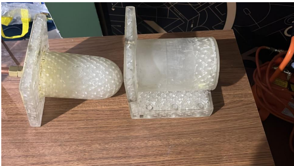
Ilustración 14-3: Moldes en resina translúcida
