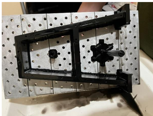
Ilustración 52-3: Soporte del mezclador y rodete en resina
