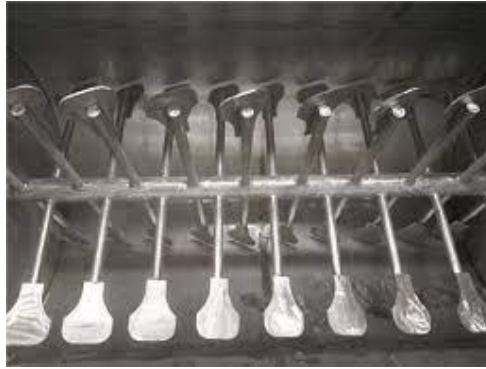
Ilustración 2-2: Mezclador horizontal de paletas planas
