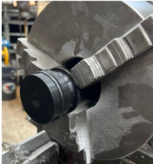
Ilustración 59-3: Embolo mecanizado en nailon
