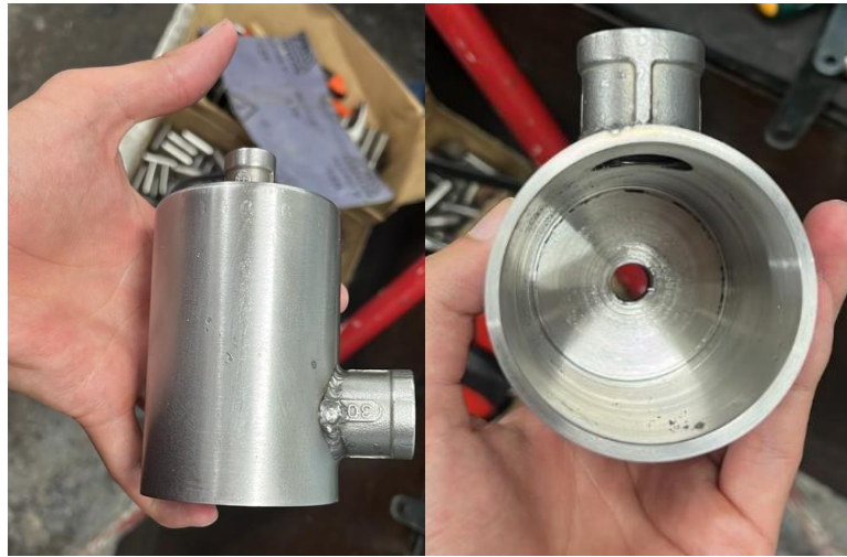
Ilustración 58-3: Cámara de inyección mecanizada en acero inoxidable
