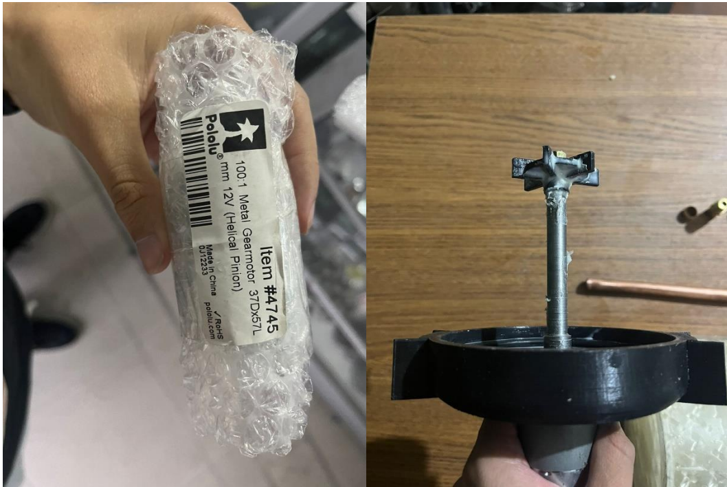
Ilustración 53-3: Motor 100:1 para el agitador
