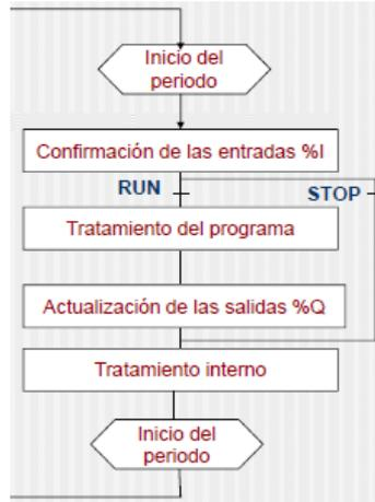
**Figura II - 22 Ejecución periódica del PLC**
