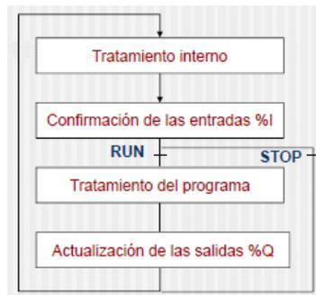
**Figura II - 21 Ejecucion normal (ciclica) del PLC**
