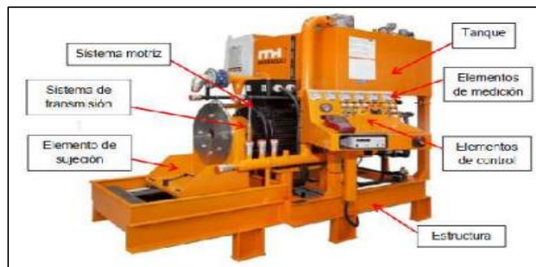
Ilustración 2-19: Elementos de un banco de pruebas hidráulicas
