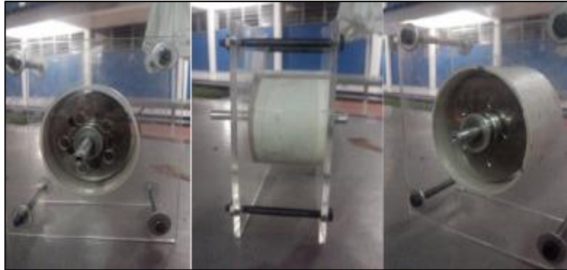
Ilustración 2-22: Turbina Tesla de aire para uso en un laboratorio
