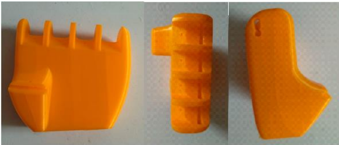
Ilustración 19-3: Prototipado rápido de la palma.
