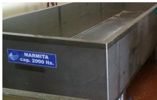
**Imagen 11.** Tina de requesón, que presenta soldaduras en las esquinas que no facilitan la fácil limpieza y desinfección.
