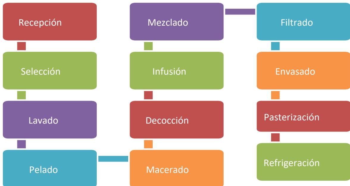
**Ilustración 15-3:** Diagrama de flujo del proceso de elaboración de la bebida de flor de Jamaica.
